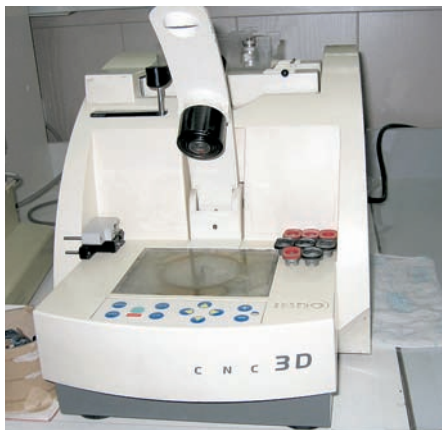
Один сканер формы оправ «СМС 2DA» применяется для работы на двух станках
